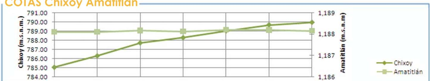
La cota de Chixoy presenta un valor de 785.07 a 789.95 m.s.n.m. con una variación de 4.88 m. La cota de Amatitlán presenta un valor de 1,188.1 a 1,188.14 m.s.n.m. con una variación de 0.04 m. Cota de rebalse de Chixoy: 803 m.s.n.m.
